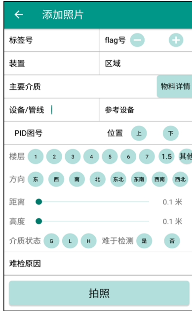
图 3.2.4-1 现场建档时手操器界面示例
